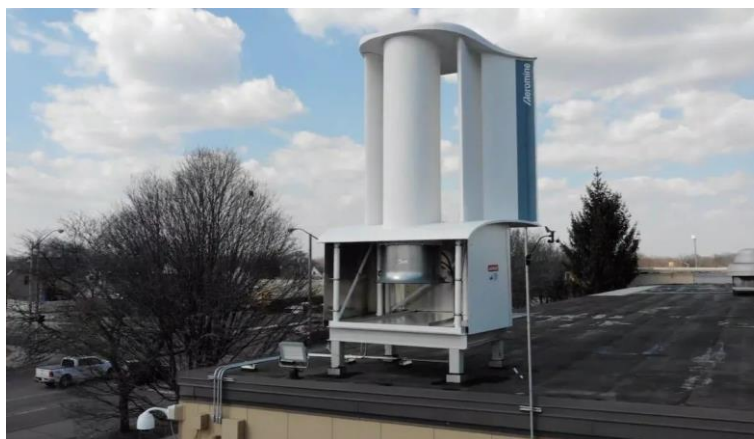
Obrázek 50: Inovativní bezlopatková VtE. Vortex Bladeless (vlevo) a VtE Aeromine Technologies (vpravo).
