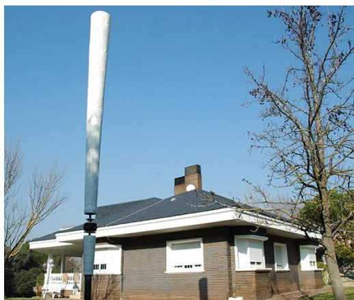
Obrázek 50: Inovativní bezlopatková VtE. Vortex Bladeless (vlevo) a VtE Aeromine Technologies (vpravo).
